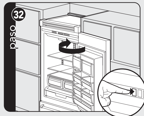
Oprima el pad de "ACTIVATE CONTROLS" y cierre la puerta. NOTA: La unidad se demora 6 minutos en comenzar a funcionar.
